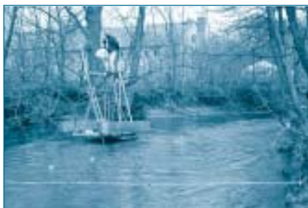
Messung von Turbulenzcharakteristiken mit Hilfe der Particle-Tracking-Velocimetry-Technik (Lagrangesche Methode).
