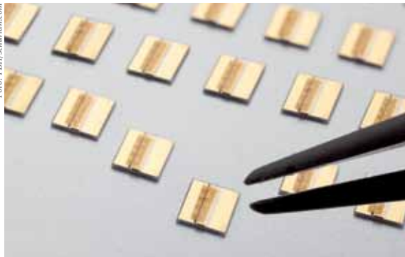
Hunderte solcher reiskorngroßer Diodenlaser aus dem FBH versorgen einen Hochintensitätslaser mit Energie.
