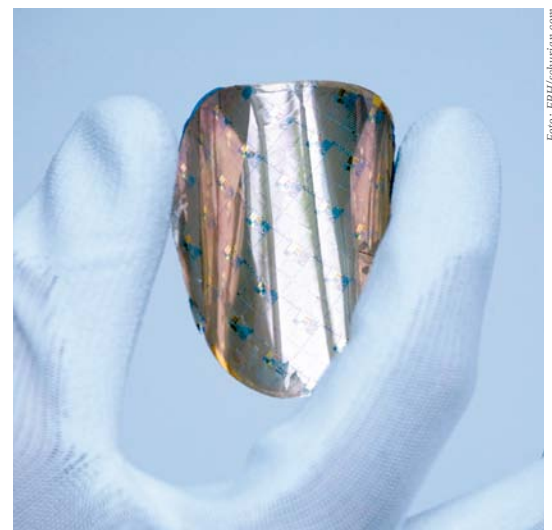
Indium-Phosphid-basierte Schaltungen in Folientechnologie am FBH.
