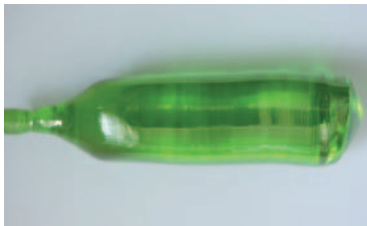
Werden am IKZ gezüchtet – Seltenerdscandate mit nur geringfügig voneinander abweichenden Gitterkonstanten: Praseodymscandate (grün, kleinste Gitterkonstante), Neodymscandate (violett), Dysprosiumscandate (orange, größte Gitterkonstante).
