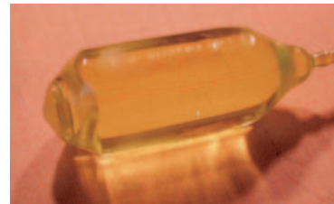
Werden am IKZ gezüchtet – Seltenerdscandate mit nur geringfügig voneinander abweichenden Gitterkonstanten: Praseodymscandate (grün, kleinste Gitterkonstante), Neodymscandate (violett), Dysprosiumscandate (orange, größte Gitterkonstante).
