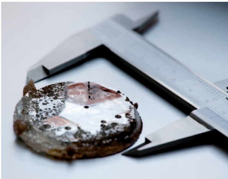
Der GaN-Kristall mit 6,3 Millimeter Dicke ist innerhalb von 14 Stunden gewachsen.
