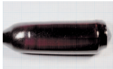
Werden am IKZ gezüchtet – Seltenerdscandate mit nur geringfügig voneinander abweichenden Gitterkonstanten: Praseodymscandate (grün, kleinste Gitterkonstante), Neodymscandate (violett), Dysprosiumscandate (orange, größte Gitterkonstante).
